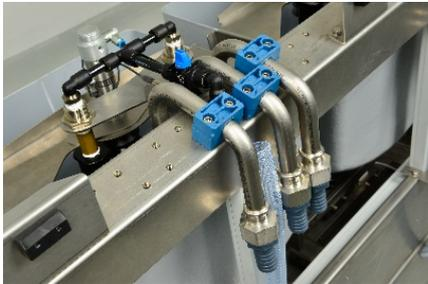
In der Grundausrüstung sind 3 Zusatzmitteleinläufe enthalten, das Gefälle nach unten reduziert den Nachlauf, einfaches Nachrüsten auf 8 Einläufe pro Behälter für Schlauchdurchmesser 25 oder 30mm
