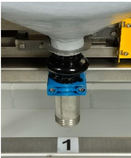
Gute Zugänglichkeit zu den Wägezellen und den Dehnungsmuffen, Schlauchanschluss für den Mischereinlass mit Entlüftungsanschluss nach oben, verhindert die Bildung von Vacuum im Ablaufschlauch zum Mischer.
